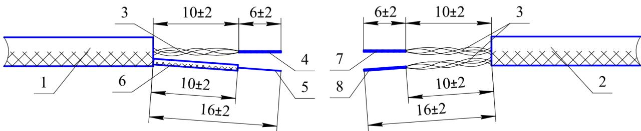
1 – кабель ЧЭ; 2 – кабель НЧЭ; 3 – центральные проводники кабелей; 4 – скрученные жилы центральных проводников кабеля; 5 – дренажная жила экрана; 6 – трубка изоляционная; 7 – свитые жилы четырёх центральных проводников без полоски (соединяются со скрученными жилами центральных проводников ЧЭ); 8 – свитые жилы четырёх центральных проводников с полосками (соединяются с дренажной жилой экрана ЧЭ).
