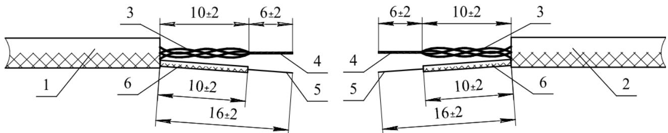
1 – кабель ЧЭ; 2 – кабель ЧЭ; 3 – центральные проводники кабелей; 4 – скрученные жилы центральных проводников кабелей; 5 – дренажные жилы экрана; 6 – трубы изоляционные
