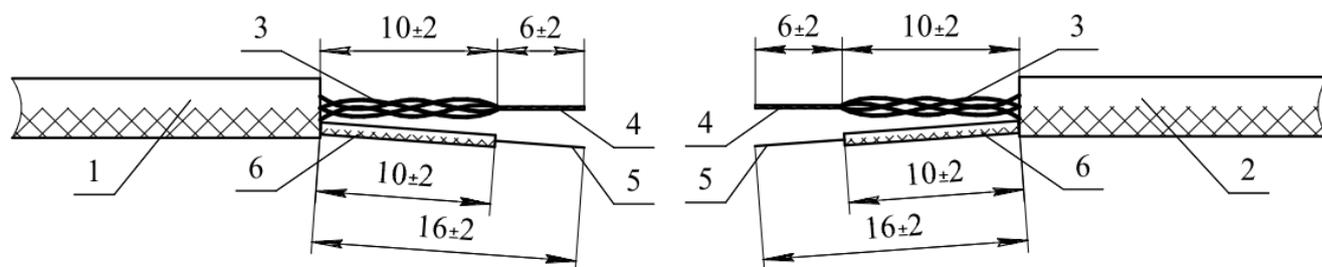
1 – кабель ЧЭ; 2 – кабель ЧЭ; 3 – центральные проводники кабелей; 4 – скрученные жилы центральных проводников кабелей; 5 – дренажные жилы экрана; 6 – трубки изоляционные
