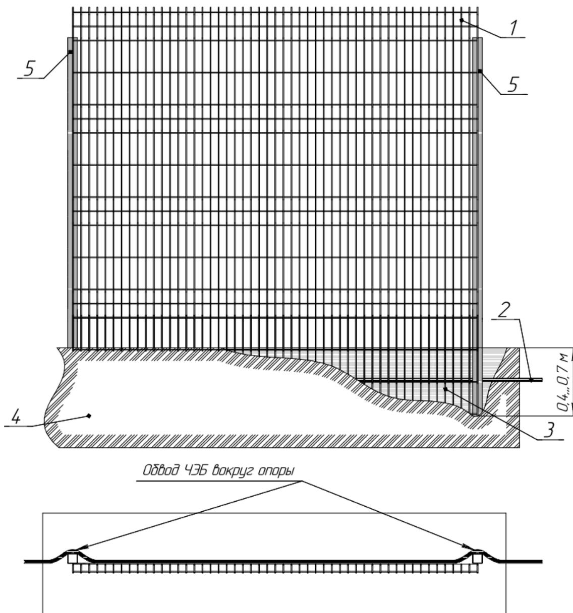
1 – СЗ; 2 – ЧЭБ; 3 – сетчатое СЗ, заглублённое в грунт; 4 – грунт; 5 – опора СЗ
