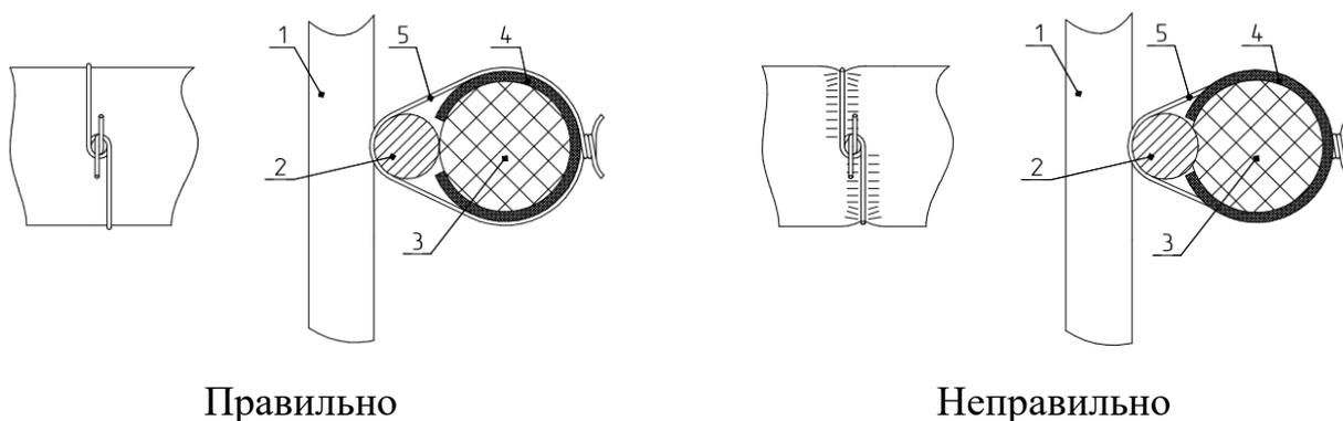
1 – вертикальная проволока полотна СЗ; 2 – горизонтальная проволока полотна СЗ; 3 – ЧЭ; 4 – втулка крепления ЧЭ; 5 – проволока
