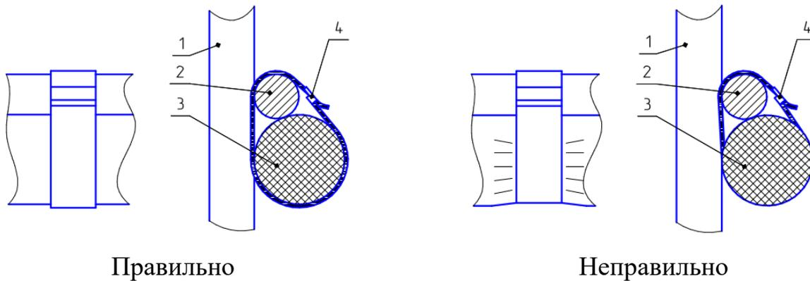
1 – вертикальная проволока полотна СЗ; 2 – горизонтальная проволока полотна СЗ; 3 – ЧЭ; 4 – стяжка кабельная стальная
