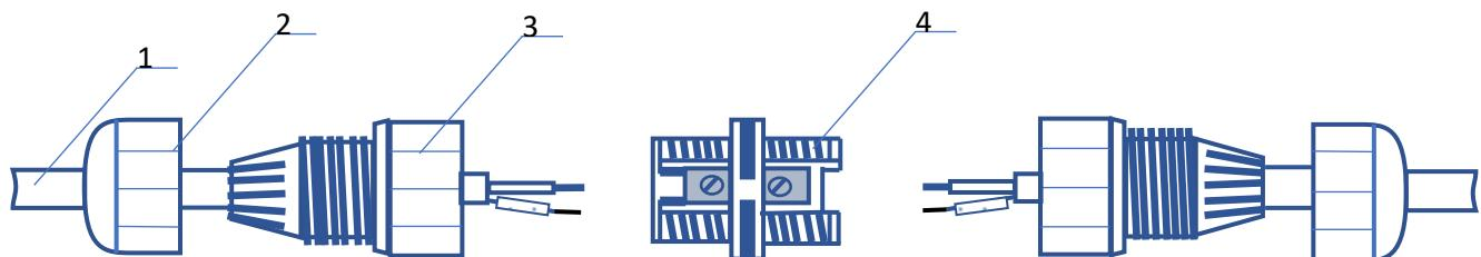
1 – кабель; 2 – гайка; 3 – футерка с цанговым зажимом; 4 – колодка коммутационная винтовая
