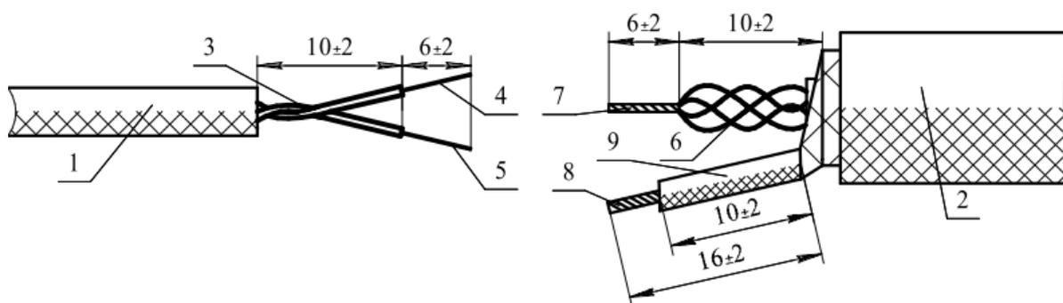
1 – НЧЭ; 2 – ЧЭБ; 3 – витая пара НЧЭ; 4 – проводник 2 НЧЭ; 5 – проводник 1 НЧЭ; 6 – спиральные проводники ЧЭБ; 7 – скрутка спиральных проводников ЧЭБ; 8 – скрутка экрана ЧЭБ; 9 – изоляционная трубка
