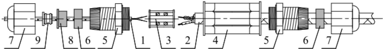
1 – НЧЭ; 2 – ЧЭБ; 3 – колодка коммутационная винтовая; 4 – втулка полая соединителя; 5 – футера с цанговым зажимом; 6 – уплотнитель резиновый кольцевой; 7 – гайка; 8 – уплотнитель резиновый т-образный; 9 – уплотнитель кабеля ФРСБ.713671.001-01 (из комплекта поставки)
