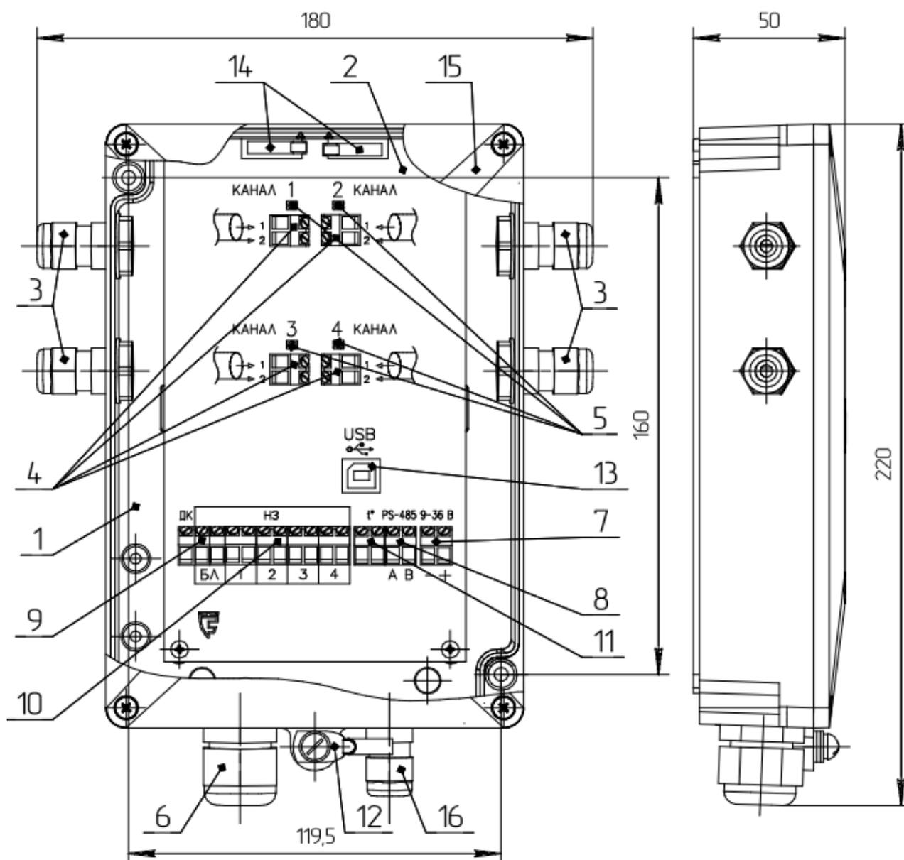
Рисунок 1.1 (Лист 1 из 2) – Конструкция блока БОС извещателя
