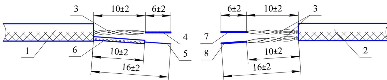
1 – кабель ЧЭ; 2 – кабель НЧЭ; 3 – центральные проводники кабелей; 4 – скрученные жилы центральных проводников кабеля; 5 – дренажная жила экрана; 6 – трубка изоляционная; 7 – свитые жилы четырёх центральных проводников без полоски (соединяются со скрученными жилами центральных проводников ЧЭ); 8 – свитые жилы четырёх центральных проводников с полосками (соединяются с дренажной жилой экрана ЧЭ).
