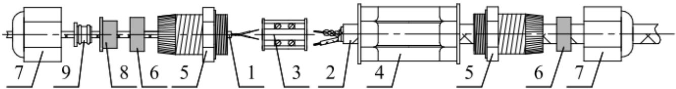
1 – НЧЭ; 2 – ЧЭБ; 3 – колодка коммутационная винтовая; 4 – втулка полиая соединителя; 5 – футора с цанговым зажимом; 6 – уплотнитель резиновый кольцевой; 7 – гайка; 8 – уплотнитель резиновый т-образный; 9 – уплотнитель кабеля ФРСБ.713671.001-01 (из комплекта поставки)
