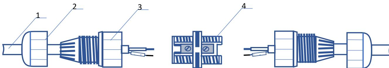
1 – кабель; 2 – гайка; 3 – футорка с цанговым зажимом; 4 – колодка коммутационная винтовая
