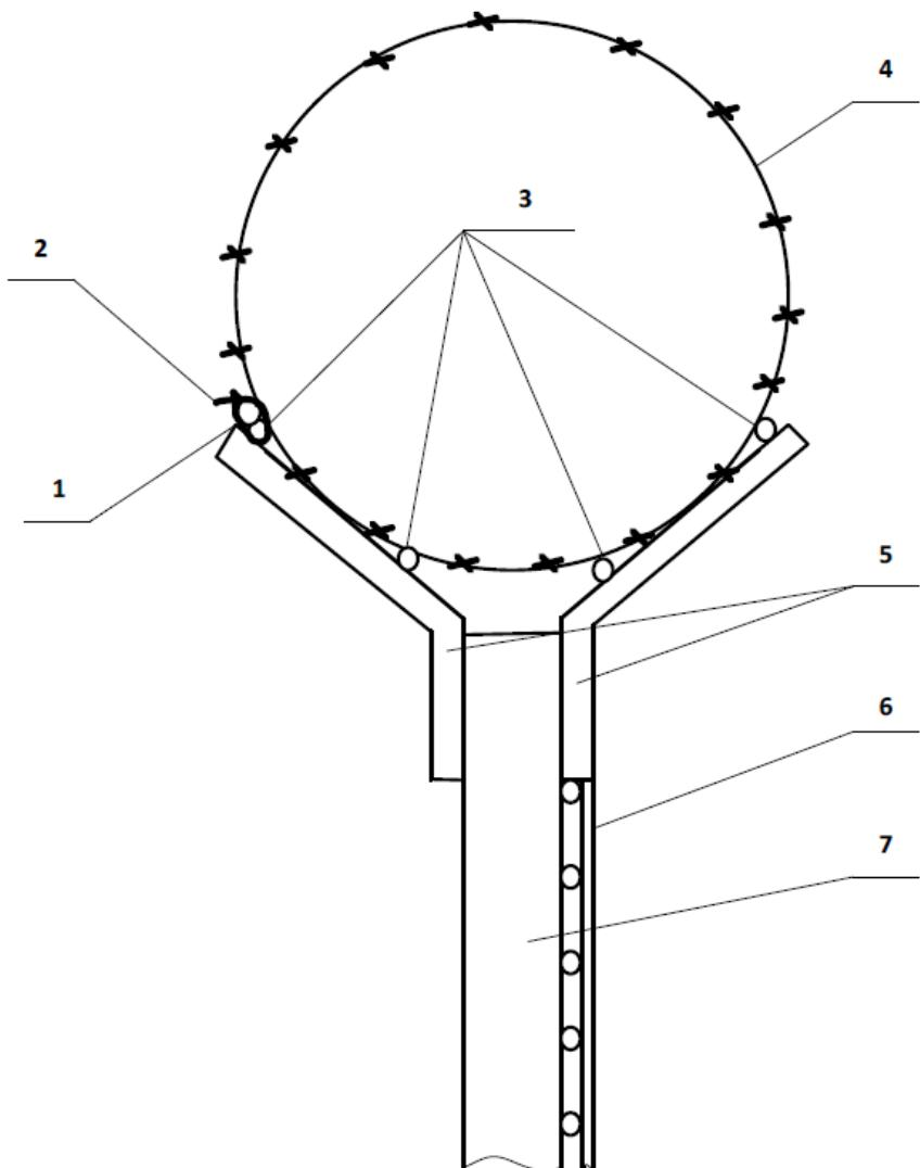
1 – ЧЭ (верхний); 2 – стяжка или втулка с проволокой стальной оцинкованной; 3 – стальная проволока (стальной трос); 4 – АКЛ; 5 - кронштейн; 6 – полотно СЗ; 7 – опора СЗ
