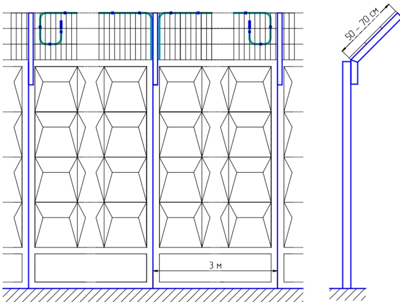
Рисунок 2.7 – Монтаж чувствительного элемента на козырьке сплошного заграждения
